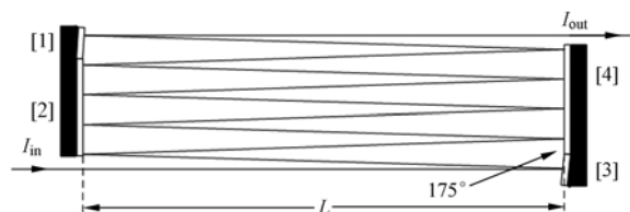
图2 多重反射式气体吸收池内部结构
